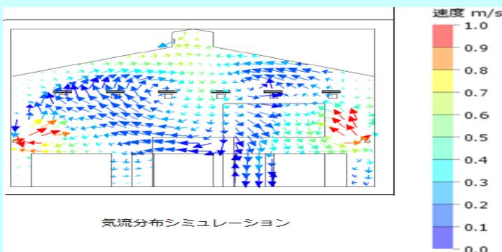
ファンメーカー(三菱電機 中津川)の気流シミュレーションにより、気流分布・温度分布を求め、機器容量の選定および導入効果を事前に評価しました。
