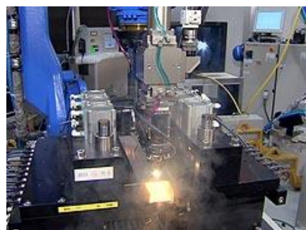
本溶接ステーションにて溶接中
