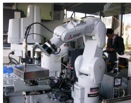
仮溶接ステーションにおいてワーク組立て
